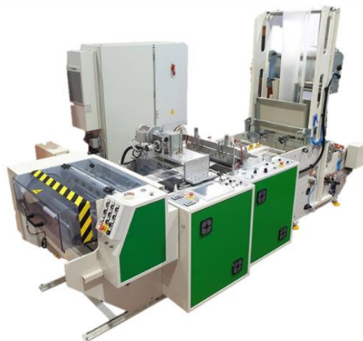
Фиг. 6. Изглед Ролна машина за производство на биоразградими торбички
